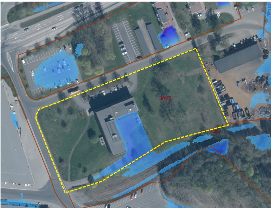
Figur 19 Lågpunkt inom området där vatten riskerar att bli stående. Simulering visar översvämning vid 15 cm nederbörd. (Scalgo Live).
