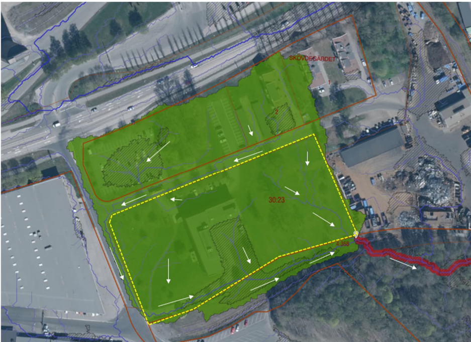
Figur 4 Ytliga flödesvägar samt avrinningsområde. Ytliga flödesvägar redovisas med blåa tunna linjer. Avrinningsriktning har förtylligats med vita pilar. Avrinningsområdet är det gröna området. Befintliga lågpunktsområden är markerade med ett grått raster. Utredningsområdet visas i gulstreckad linje.
