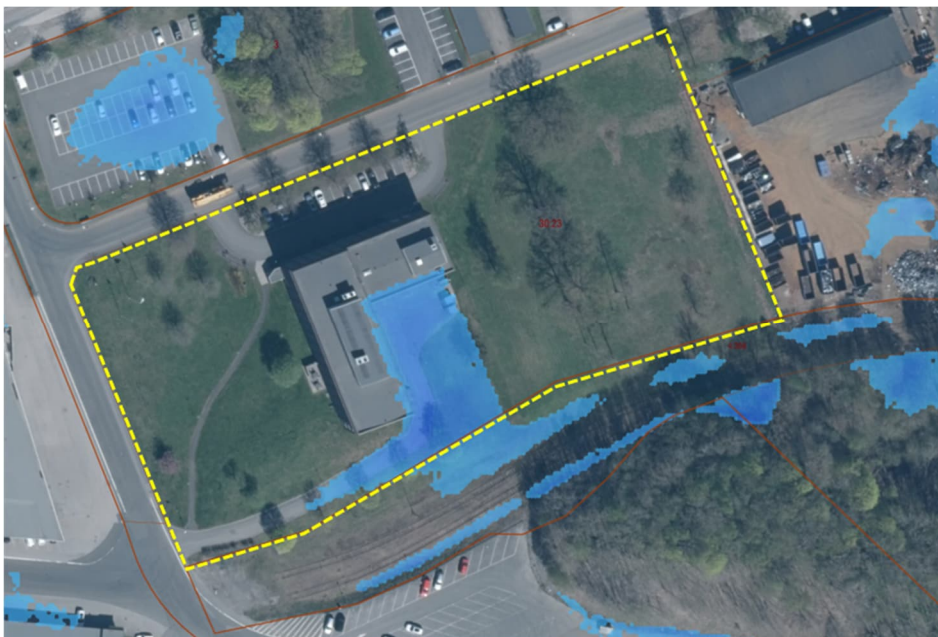
Figur 17 Lågpunkt inom området där vatten riskerar att bli stående. Simulering visar översvämning vid 69 mm nederbörd. (Scalgo Live).
