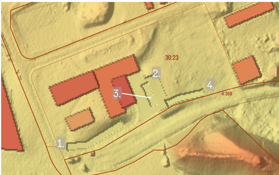
Figur 24 Föreslagna åtgärder inom planen. Punkt 1 – Svackdike. Punkt 2 – framtida parkering, lutar ut mot husfasad. Punkt 3 – makadamdike. Punkt 4 – nedsänkt yta för extra volym i händelse av skyfall. Mörkröda ytor inom planområdet är schematiskt inlagda framtida byggnader.
