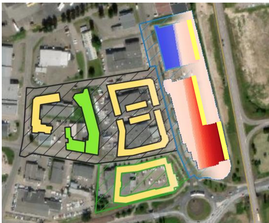
Figur 16. Gul linje markerar ytterväggskonstruktion inklusive dörrar som ska utformas i minst EI30, fönster ska utformas i minst EW30.
