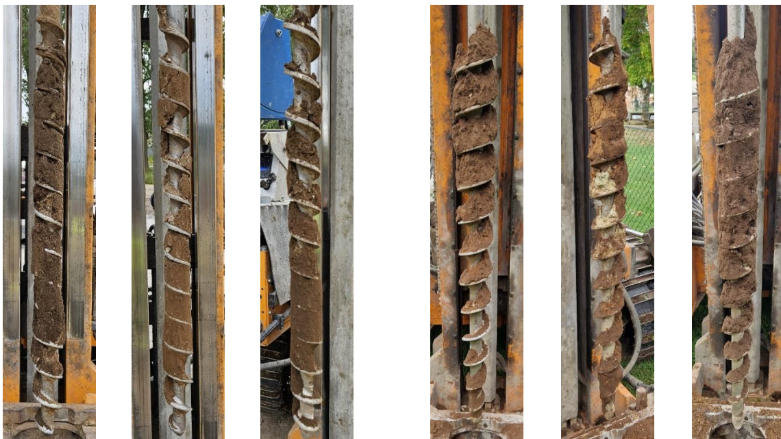
Figur 3. Jordprovtagning i punkt 2402 med skruvborr på bandvagn med markprofilen i 0–1 m (vänster) 1–2 (mitten) resp. 2–3 m (höger) djup.
