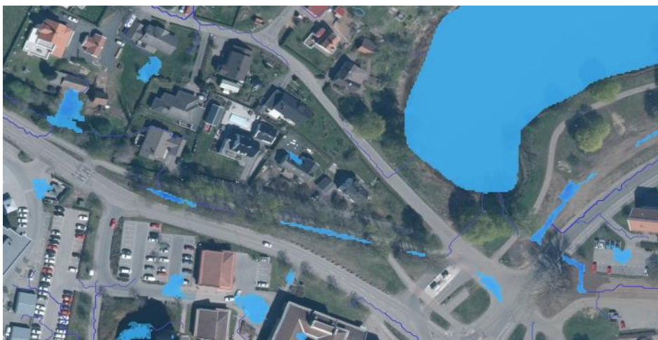
Figur 14. Översiktliga rinnvägar av ett klimatanpassat 100-årsregn med 10 minuters varaktighet. (Röda pilar avser förtydligande avseende avrinningens riktning). (Scalgo 2024)
